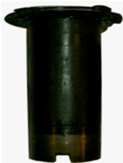
Elle se retire sans difficultés. En la replaçant, il faut vérifier que le méplat de la chemise se trouve du côté culbuterie. Il faut faire rentrer les segments dans la chemise afin d'éviter leur rupture.
