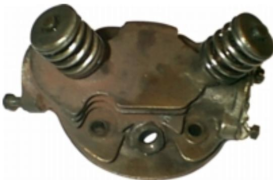
La culasse peut se démonter moteur dans le cadre, après dépose du bloc culbuteur. Il suffit de dévisser les quatre écrous de maintien ainsi que les quatre écrous gougeons. Pour un démontage hors-cadre, il faut enlever le carburateur, le tube d'échappement ainsi que l'arrivée d'essence.
